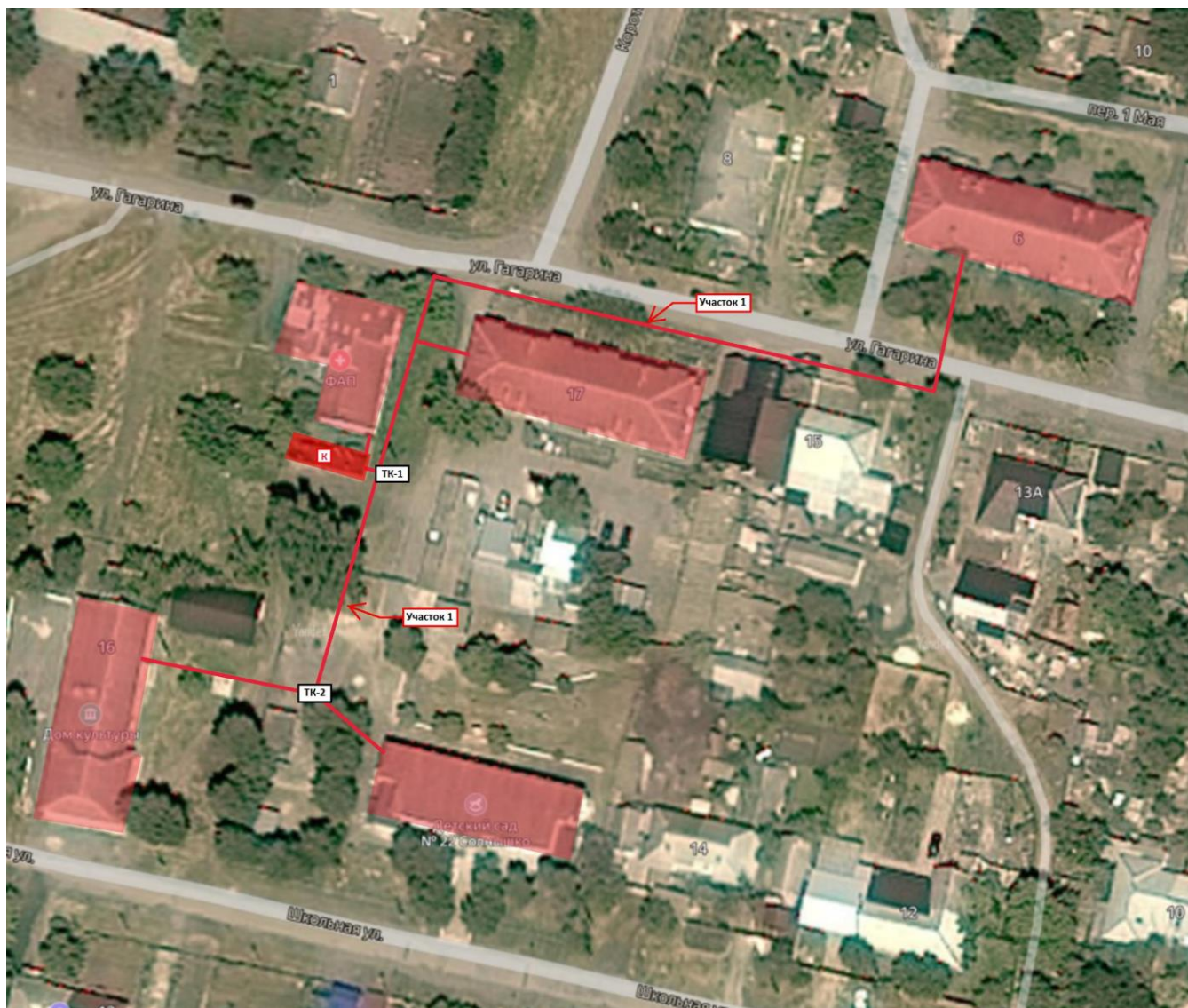
Рис. 1 – Схема тепловых сетей от котельной по адресу: п. Верхнегрушевский, ул. Гагарина, 19а
